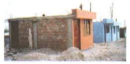
cuentan con un área promedio de 35m², que incluye un servicio higiénico. Fueron edificadas con ladrillo hecho a máquina, cimientos, columnas y techos en concreto armado. La ejecución fue por autoconstrucción, con el apoyo de mano de obra calificada y la asistencia técnica de un profesional.
